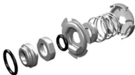
Slika 13 Šematski prikaz zaptivača vratila
