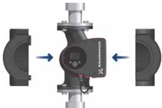
Slika 47 Postavljanje izolacionih obloga na MAGNA3 pumpu
